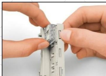
Lösen der Verbindungs-klemme aus dem Befestigungsadapter
