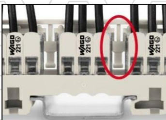
Einbauweise 440V Positionierung der Klemmen im Adapter mit Distanzelement zwischen den Klemmen
